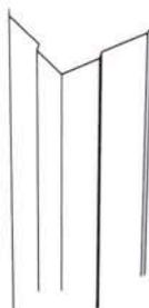
**Gancho candil** (sólo para la aplicación a librillo) de acero galvanizado de 2 mm. de espesor
